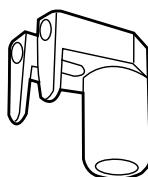
El actuador dispone de dos orificios por los que se dispensa el líquido bacteriostático.
